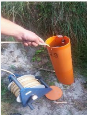
Pomiar głębokości występowania zwierciadła wód podziemnych
