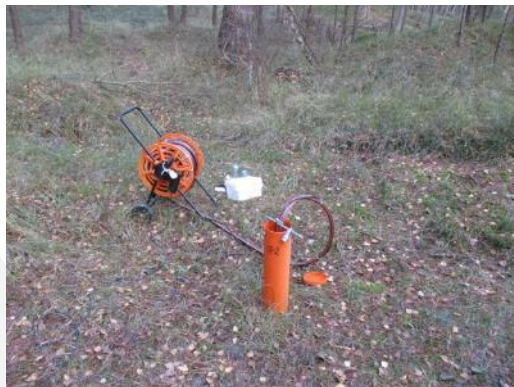
Pobór próbek wody podziemnej do badań jakościowych
